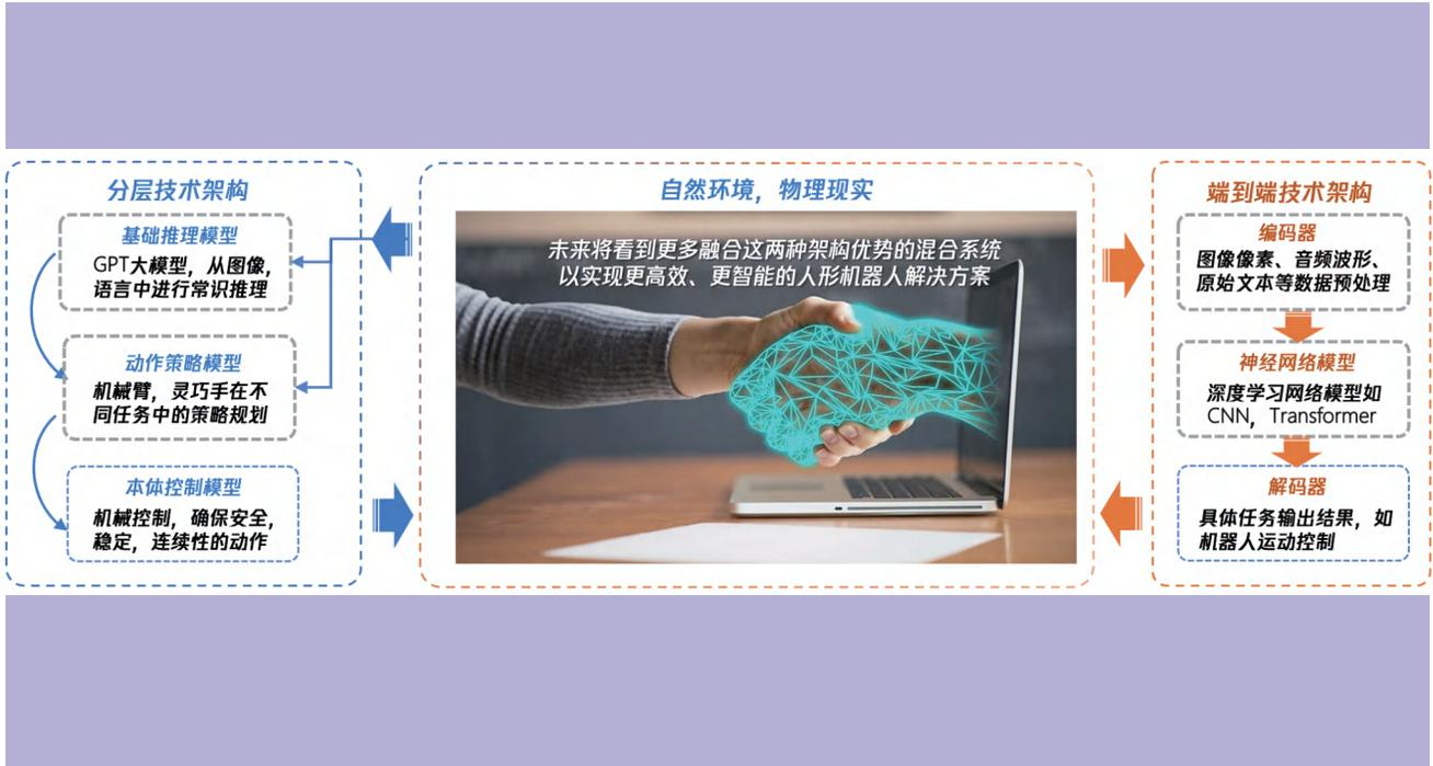
分层架构,如OpenAI和Figure所采用的,通过将感知、决策和行动分成处在不同层次的模块来处理,增强了系统的稳定性和可维护性。这种结构允许各层之间进行信息流和命令流交互,便于单独优化和调试。
