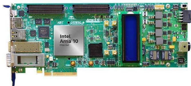
图 1. 定制 FPGA 主板的视图（适用于支持多种无线技术的基带设计）。（资料来源：英特尔）
